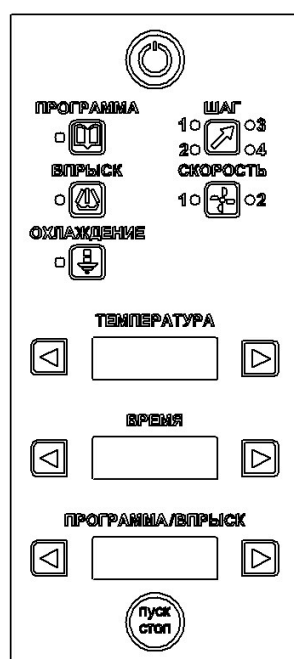
Рис. 2б Внешний вид панели управления КЭП-16.
